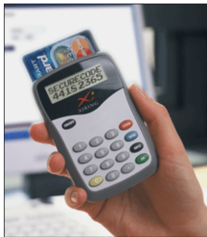
Abbildung 25: Ein Gerät zur Generierung eines einmalig verwendbaren Kennworts (Fotoquelle: www.reseaux-telecoms.net ) 37
