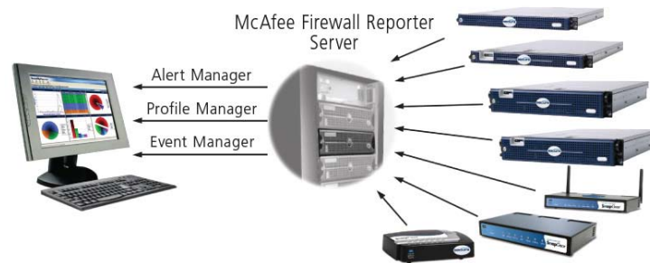
Abbildung 4: McAfee Firewall Reporter stellt eine zentrale Datenquelle für tausende von McAfee Firewall Enterprise- und McAfee UTM Firewall-Appliances dar.
