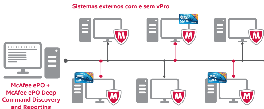
Figura 1. O McAfee ePO Deep Command descobre sistemas vPro e distribui o software para ativar o Intel AMT.
