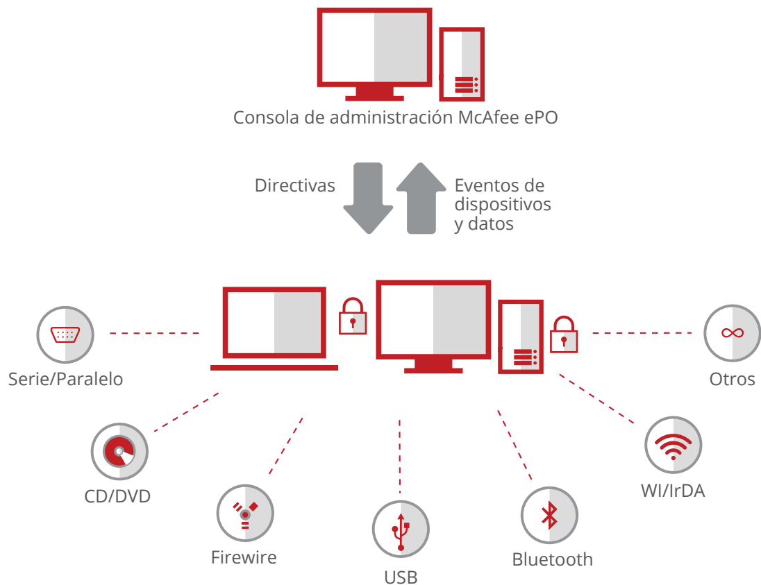
Figura 1. McAfee Device Control especifica qué dispositivos se pueden utilizar y qué datos se pueden copiar.
