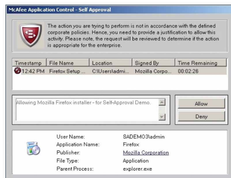
Figura 3. Agli utenti che cercano di installare applicazioni non autorizzate viene presentata una finestra di richiesta di approvazione automatica, con un avviso che spiega che la loro richiesta è in attesa dell'approvazione da parte del personale IT. Una volta approvate, le applicazioni vengono aggiunte alla whitelist, evitando richieste future.
